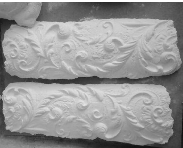
: Primer dveh štukatur iz novega apneno-mavčnega materiala | foto: arhiv ZAG | izdelava štukatur: Rok Mohar, kipar
