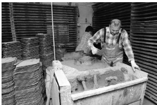
: Priprava betonske mešanice za betonsko kritino v delavnici Izidorja Jesenka Recikliran betonski strešnik | foto: erhiv ZAG
