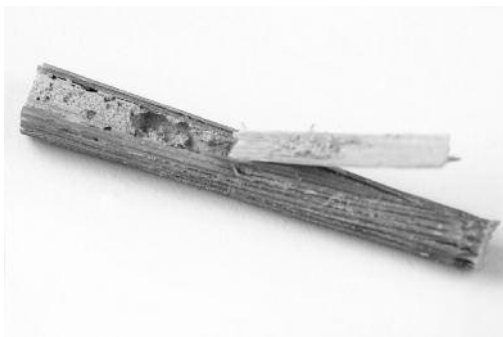
: Slama rži zapolnjena s karbonatiziranim apnenim vezivom in drobnim agregatom | foto: erhiv ZAG
